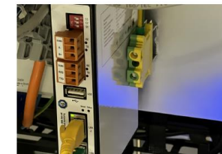
Abbildung 7: „Plug and Play“, die TÜV SÜD data box liefert Live-Daten für ein kontinuierliches Monitoring
